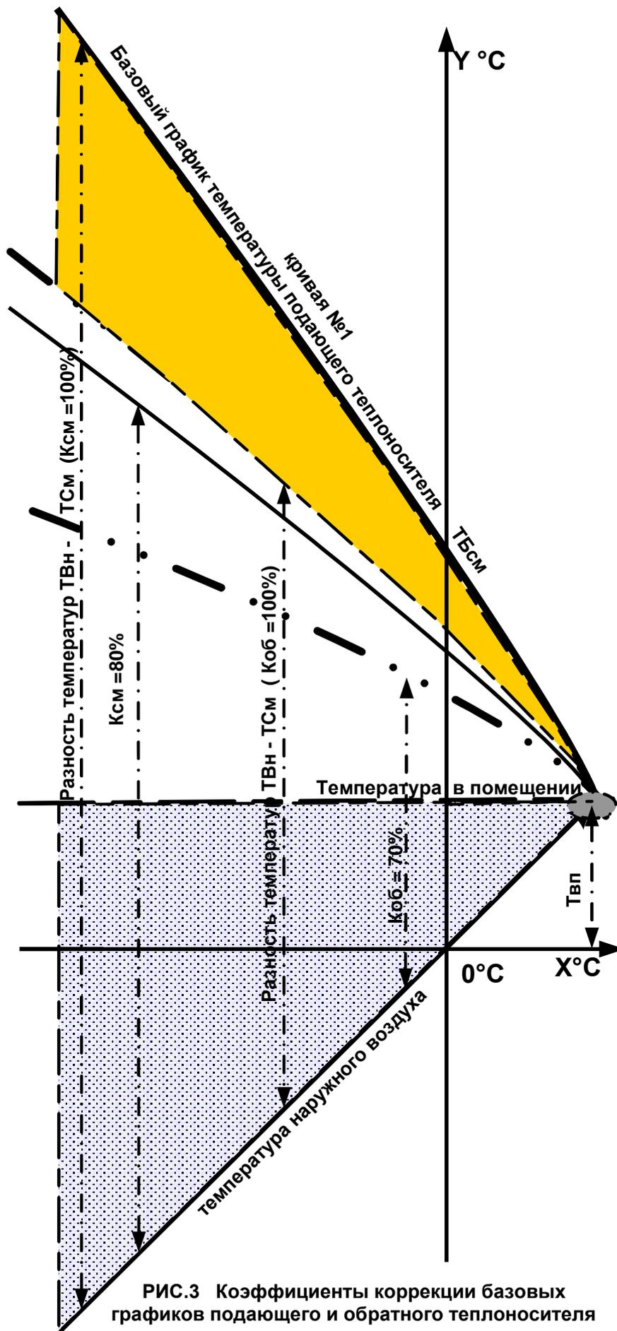
РИС.3 Коэффициенты коррекции базовых графиков подающего и обратного теплоносителя
