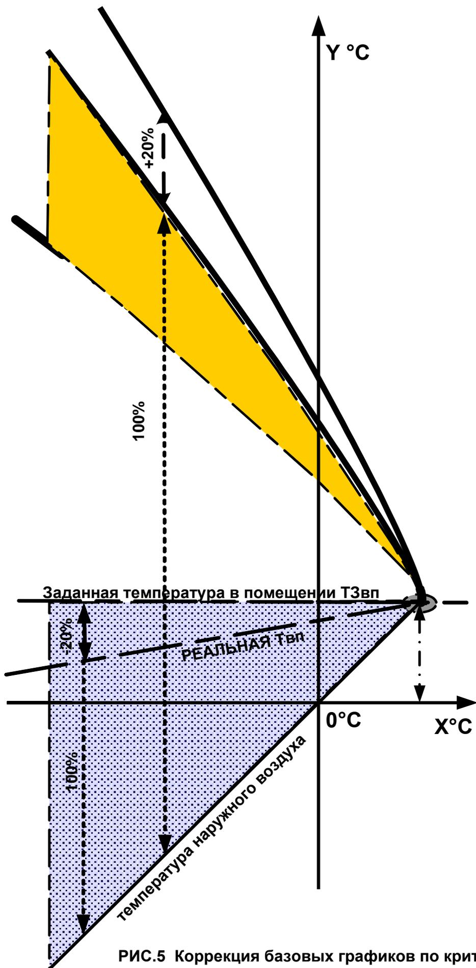
РИС.5 Коррекция базовых графиков по критерию температуры в помещении
