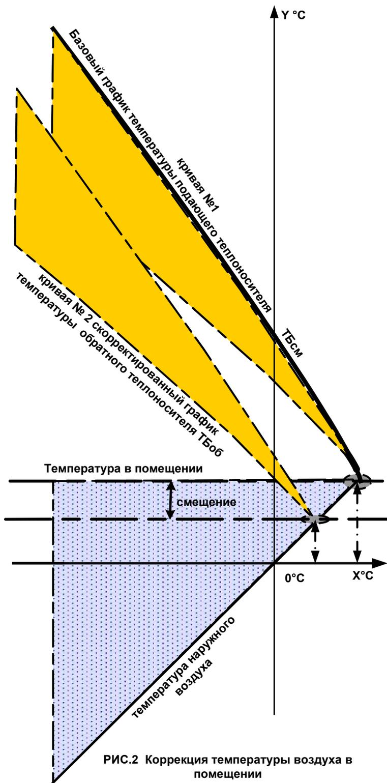
РИС.2 Коррекция температуры воздуха в помещении
