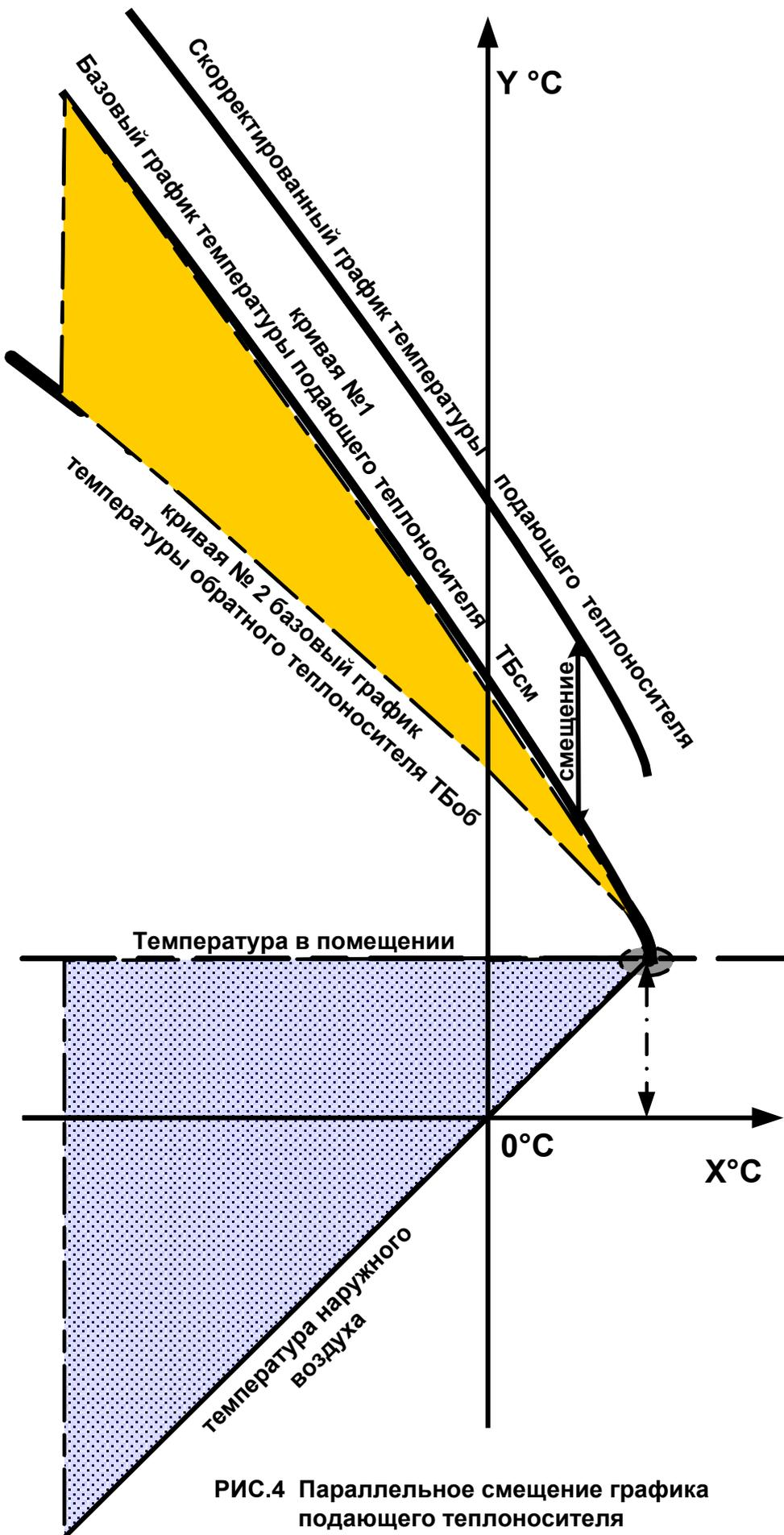
РИС.4 Параллельное смещение графика подающего теплоносителя
