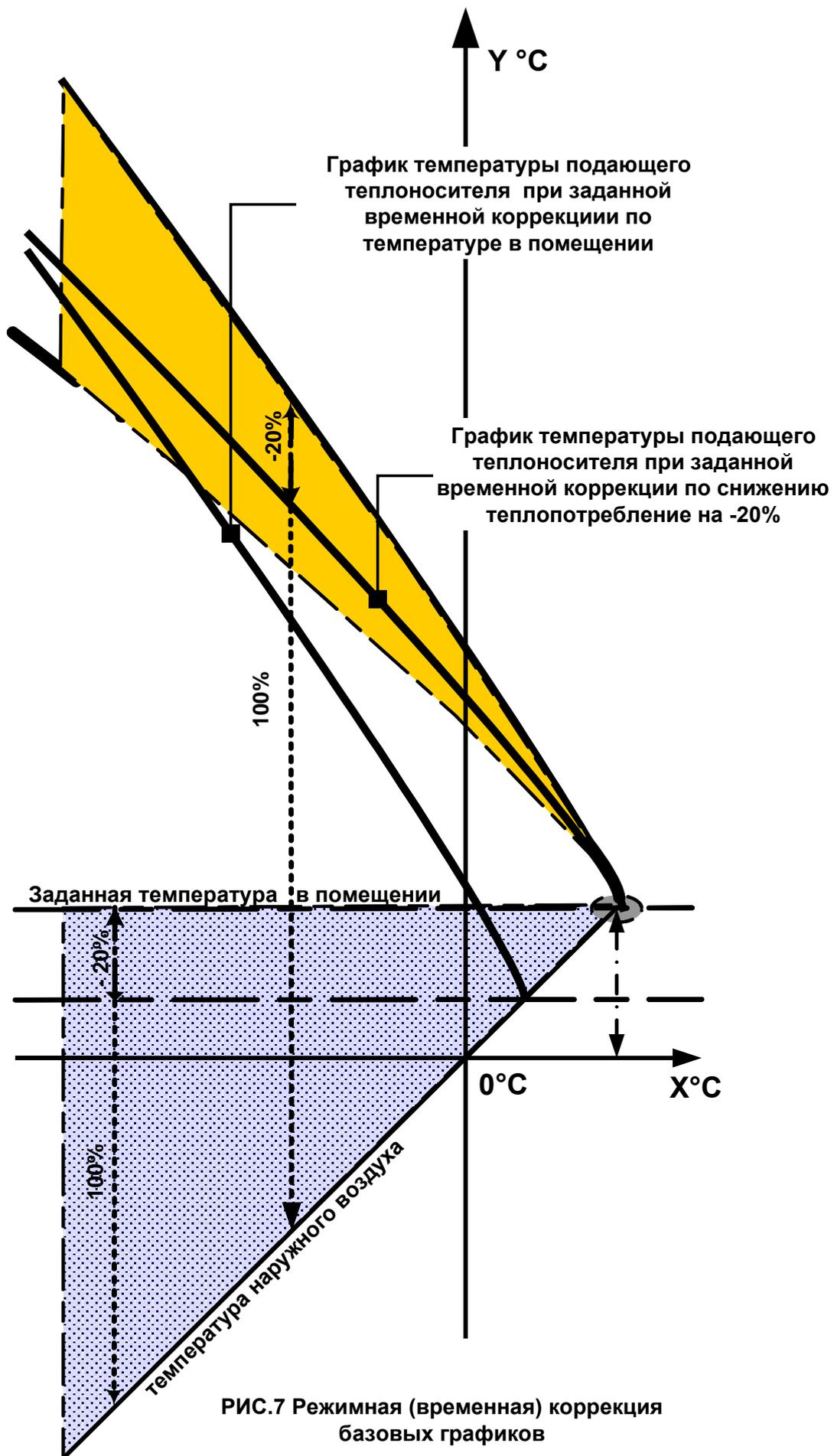
РИС.7 Режимная (временная) коррекция базовых графиков
