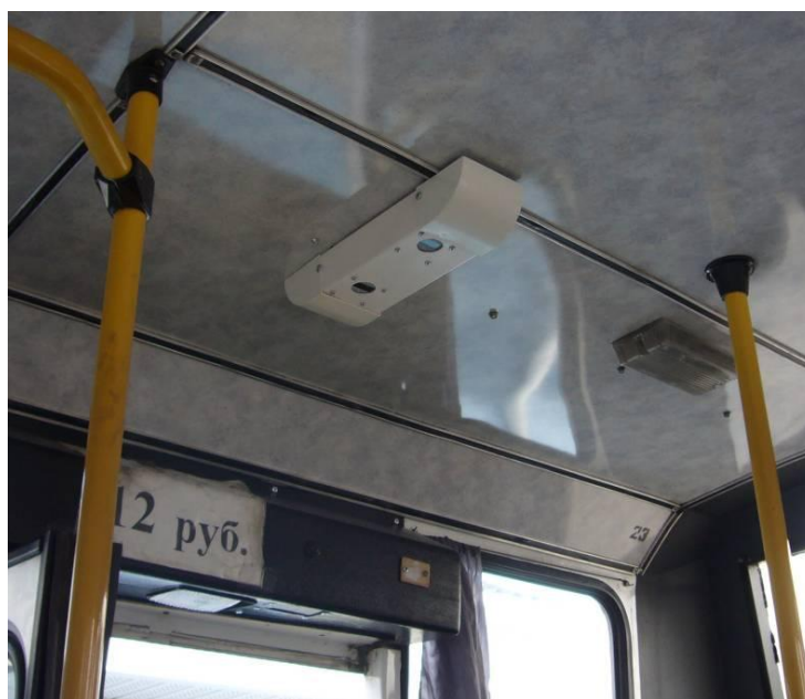
Рисунок 3.4 – Установка на одностворчатую дверь автобуса «Аврора» ИК-датчика «Луч-МС».
