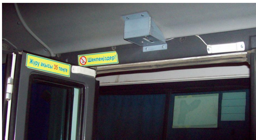
Рисунок 3.2 – Установка на одностворчатую дверь ИК-датчика «Луч-М».
