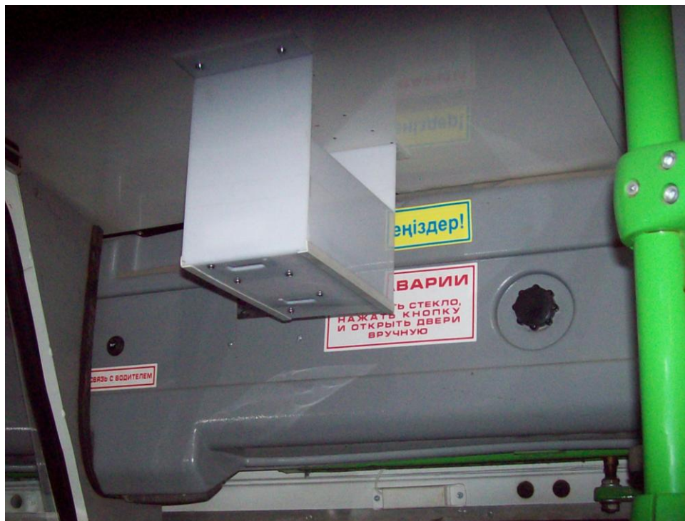
Рисунок 3.1 – Установка на одностворчатую дверь автобуса ЛиАЗ ИК-датчика «Луч-МС».
