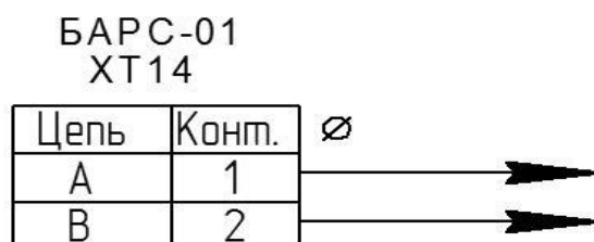
Рисунок В.2 – Схема подключения к цепям интерфейса RS-485.
