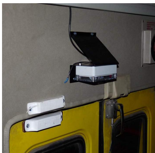
Рисунок 3.4 – Установка на одностворчатую дверь автобуса HigerBus ИК-датчика «Луч-М».
